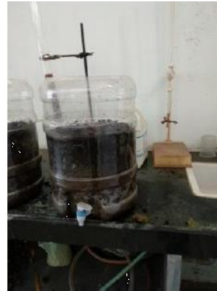
Figure-2: Vermifilter actual photo in lab.
